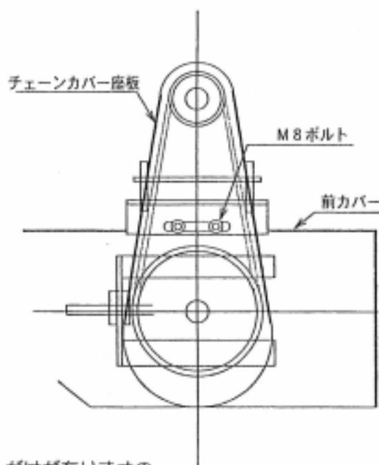
10. 外した軸カバー内に駆動軸の端部に回転用のスパナがけがありますので、これを回しチェーンがスムーズに回るように調整して下さい。
